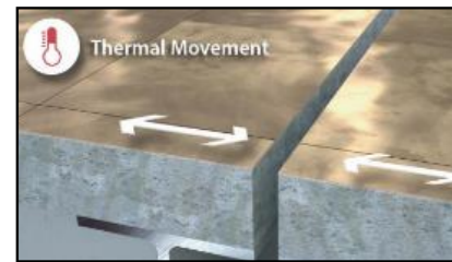
位移补偿 补偿热胀冷缩伸缩位移
